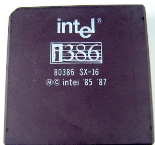
字长：32位； 晶体管数目：275K 峰值主频：40 MHz
